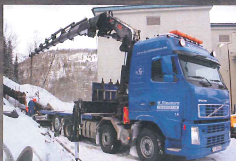
4 akslet bil, 60 t/m kran med vinsj, rekkevidde 23 meter. (2006 mod)
