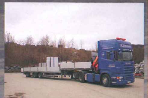
Trekkvogn m/avtagbar 16 t/m kran. Tre-akslet jumbosemi, over 30 tonn nyttelast. (2008 mod)
